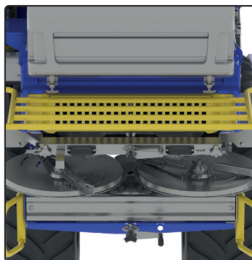
Sistema de distribución de fertilizantes mediante discos con aletas y escala para ajustes.
