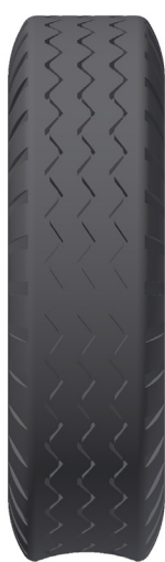
Falta de pressão
