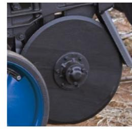
**Discos doble desencontrado:** facilita abrir el surco en profundidad homogénea para depositar la semilla, proporcionando una germinación uniforme en las líneas sembradas.
