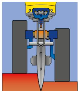
**Ruedas de profundidad:** actúan junto a los discos dobles de semilla y controlan la profundidad adecuada de siembra. La oscilación vertical e independiente de los neumáticos permite acompañar las irregularidades del terreno, proporcionando facilidad para que las plantas puedan emergir.
