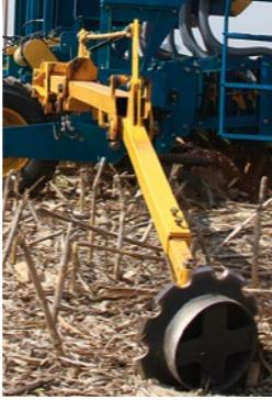
**Marcadores de línea:** articulado en tres partes, posee cilindros hidráulicos propios y ajustes para largo y ángulo del brazo, formando un sistema compacto para transporte. Fabricado con tubos estructurales y dos cilindros hidráulicos. El marcador también posee disco dentado de 15".
