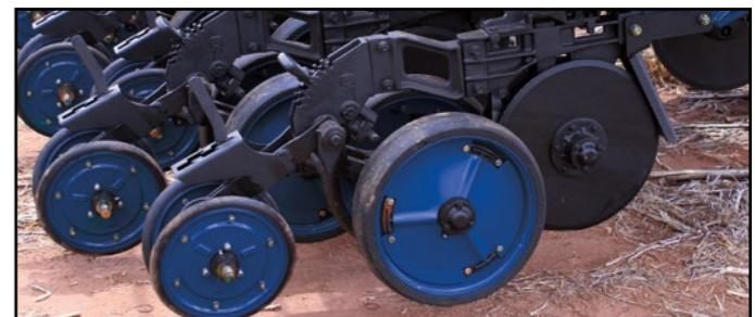
**Rueda compactadora en "V":** equipada con 5 niveles de ajustes. Las separaciones disponibles permiten el posicionamiento en "V" de las ruedas cubridoras, así como la posición desencontrada en relación a la otra. Las ruedas compactadoras presionan la camada superficial, eliminando bolsas de aire y endurecimiento del suelo o de la semilla, criando un contacto positivo entre ambos. El resultado es una germinación y distribución homogénea.
