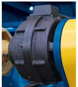
**Embrague electromagnética:** con accionamiento automático para maniobras de remates o finalización (cuando accionado el embrague, el eje de la transmisión del TRA deja de girar).
