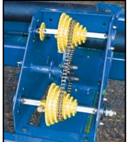
**Transmisión:** equipada con sistema TRA – cambio rápido automático, con diferentes combinaciones posibilitando una amplia gama de distribución de semillas par diferentes culturas, sin necesidad de usar herramientas.
