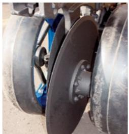
**Compactación reducida:** la disposición de armado de la rueda de control de profundidad y del disco de corte evita que la compactación sea perjudicial a la siembra realizada.
