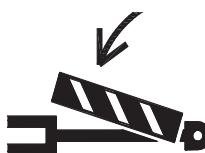
Siempre utilice las trabas para efectuar el mantenimiento y el transporte de los equipos.
