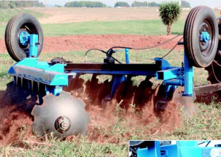
**Discos:** dentados de alta resistencia al desgaste y a los impactos.
