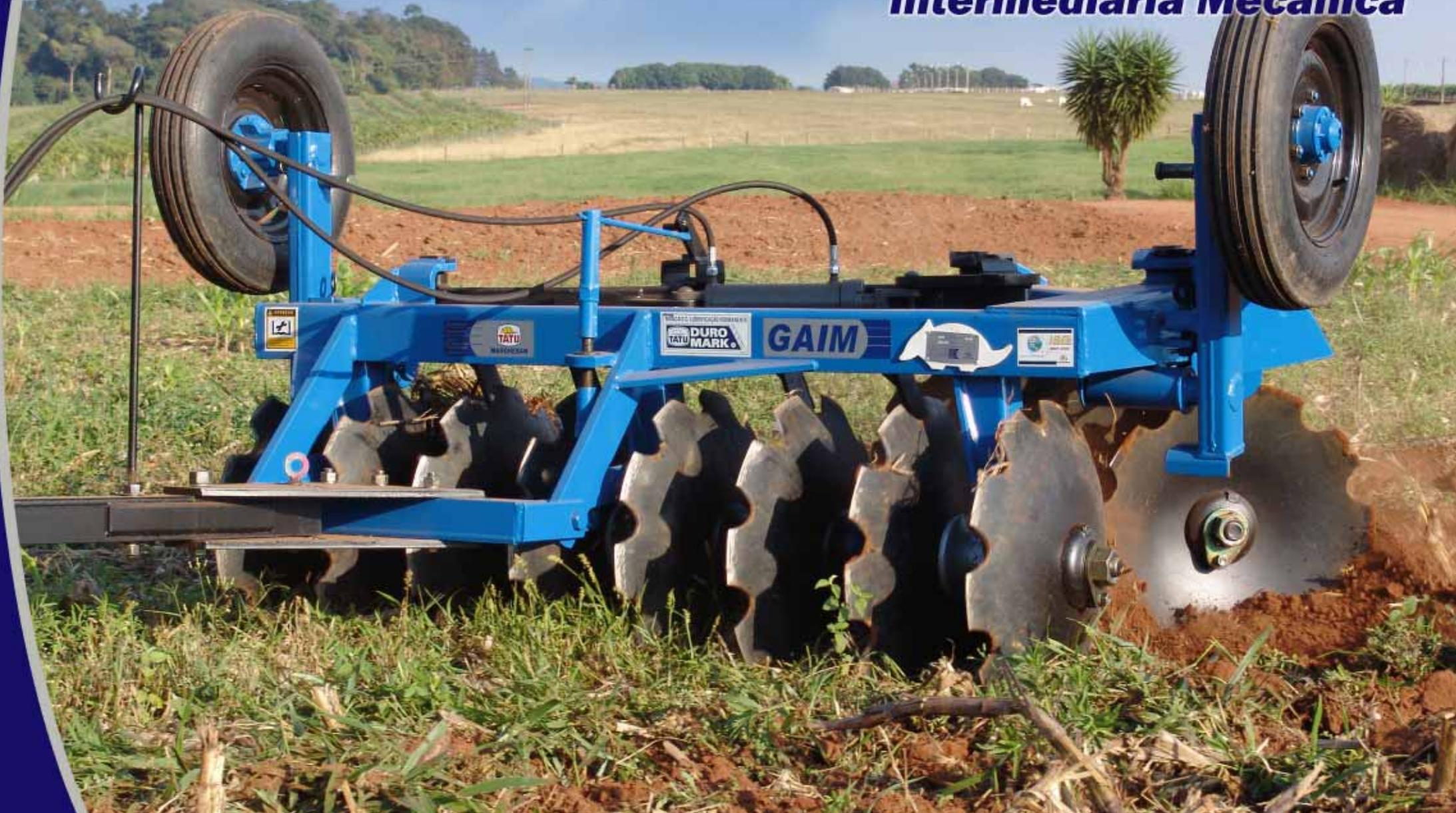
La **GAIM** es facilmente transportada a través de un sistema de rodaje simple y practico.
