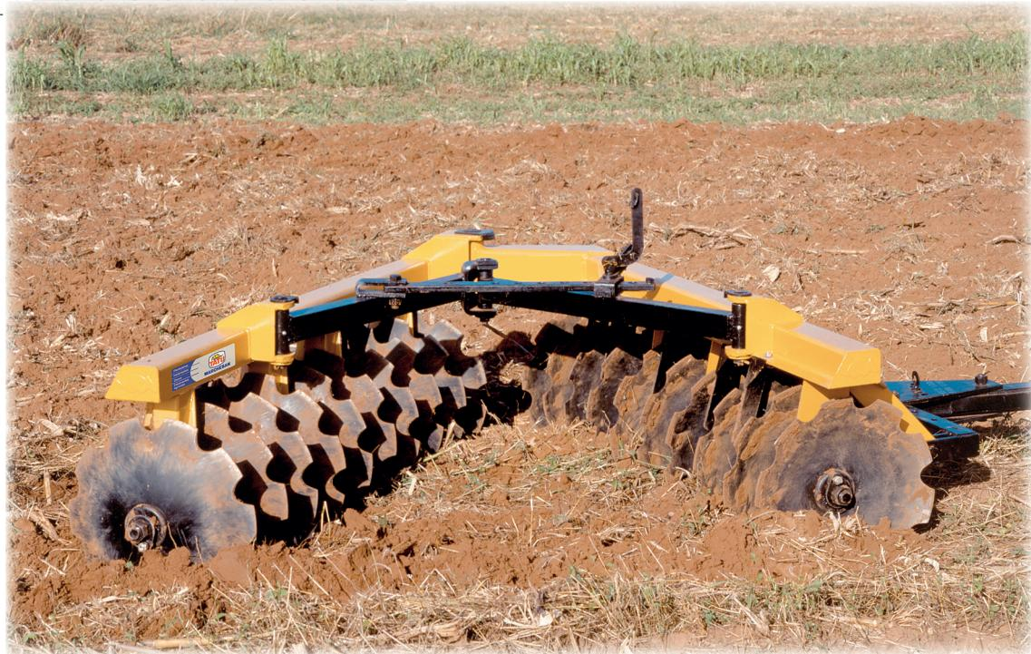
La **GA** efectua el preparo del suelo para la siembra de cereales en general, renovación de pastura o el desterronamiento, después del uso de rastras de mayor tamaño. Le Rastra Aradora posee una estructura reforzada y discos de alta calidad, con superior resistencia al desgaste y a los impactos.
