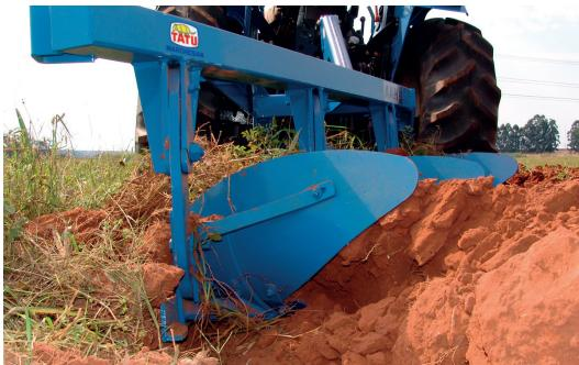
El Arado de Vertederas Helicoidales, modelo **AAH**, efectúa el trabajo de aración, incorporación de restos de vegetales en cualquier tipo de suelo. Operando en mayor profundidad, permite la erradicación de plantas indeseables, elimina camadas compactas, aumenta el volumen del suelo explorando las raíces y disponibilizando mayor cantidad de agua y nutrientes para la cultura.
