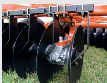
Zapata tipo "C" para fijación de las chumaceras, para mantener la profundidad de aración y trabajar en cualquier tipo de suelo.
