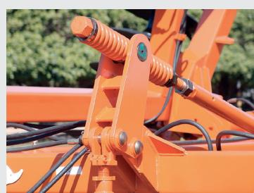
Reglaje de nivelación del equipo para transporte a través del huso regulador. Huso de reglaje para control de profundidad individual de los cuadros laterales.
