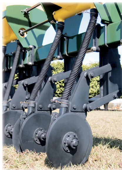
Módulos con mayor curso de flotación y profundidad fácilmente ajustables.
