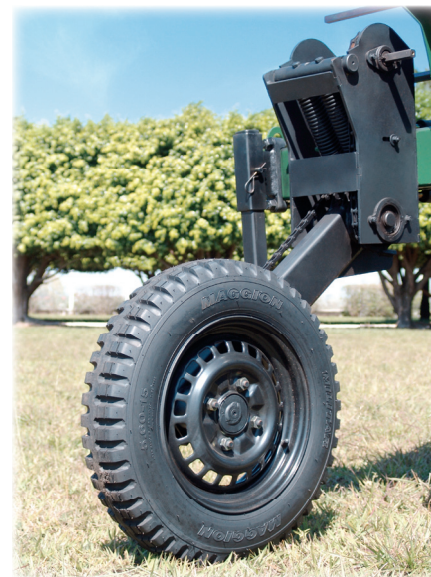
Accionamiento de la abonadora a través de neumáticos militares 5.60 x 15.
